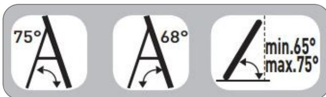
Plusieurs inclinaisons possibles: 75° et 68°. À 68°, les échelons sont droits et offrent une surface plane pour plus de confort.
